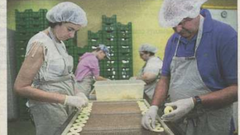
Die Apfelchenbeiben werden auf Roste verteilt und anschließend getrocknet. (PHOTO: JACQUEM VALENTI)
